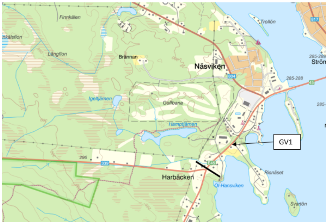
Figur 1: Pil visar på ett ungefär var GV1 ligger. Svart streck visar vart halkbekämpning med saltlake upphör.
